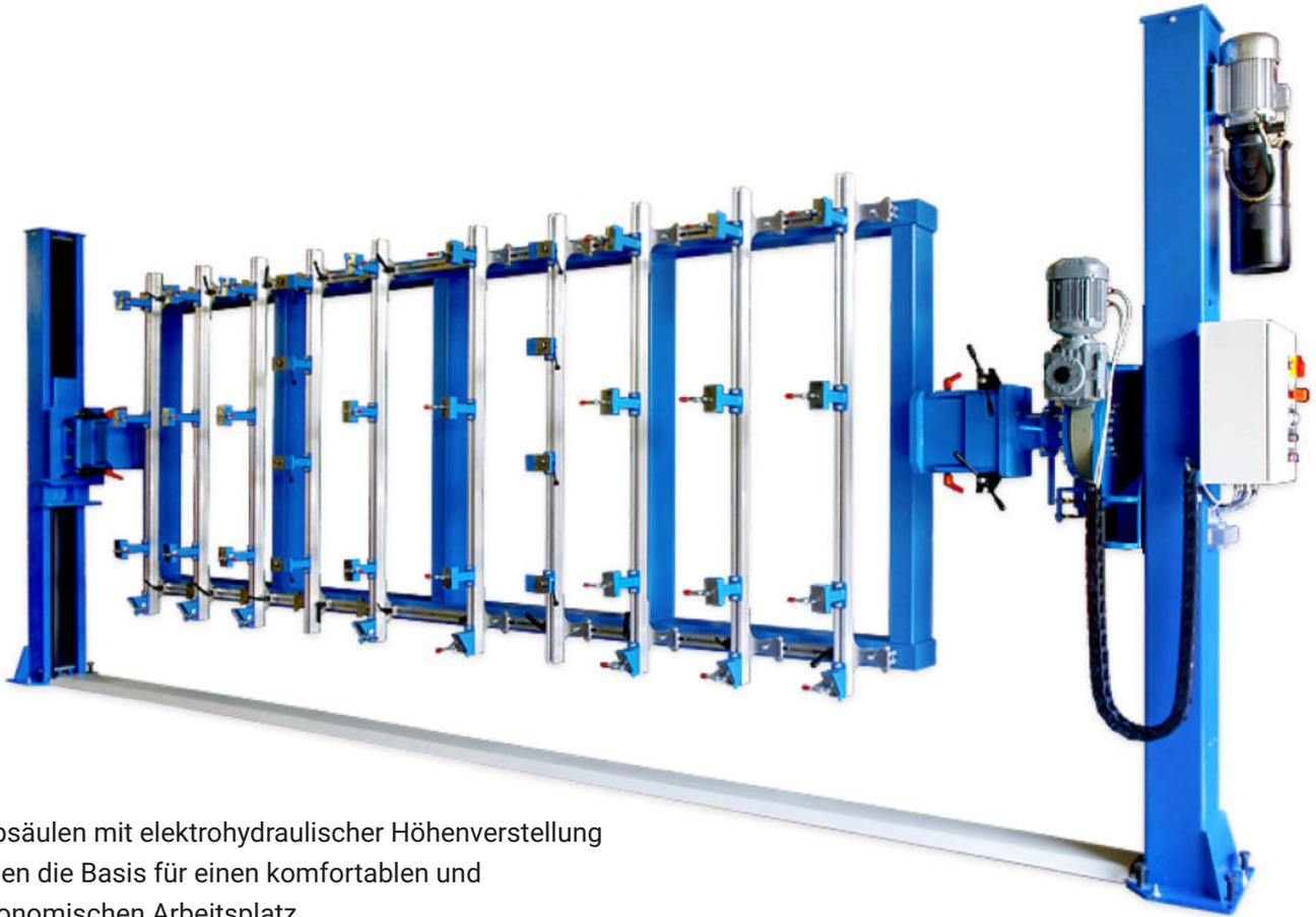
Hubsäulen mit elektrohydraulischer Höhenverstellung bilden die Basis für einen komfortablen und ergonomischen Arbeitsplatz.
