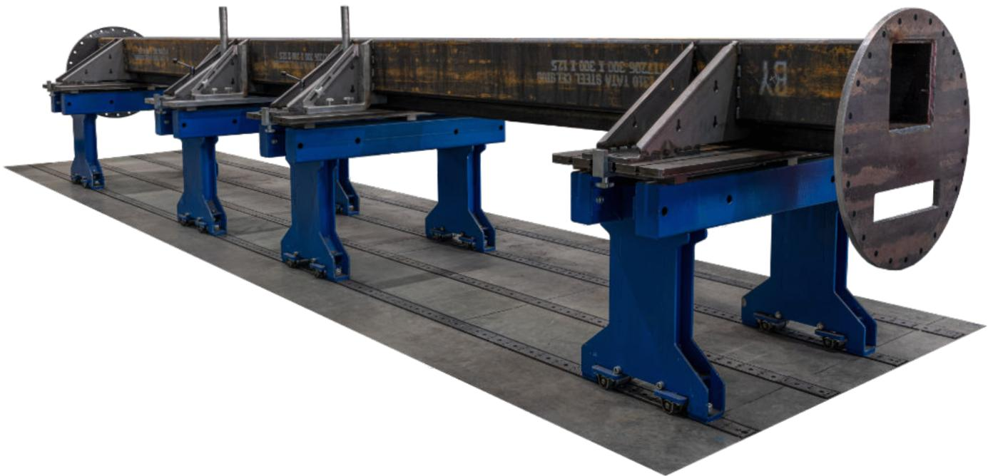
Unser Schienensystem ist zur Montage in oder auf Beton ausgelegt und ist in Länge und Breite beliebig ausführbar.
