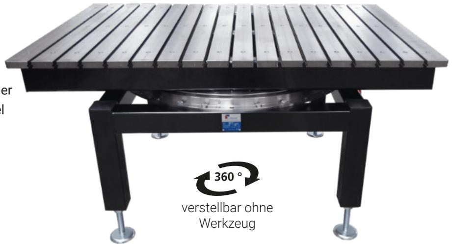
• Punktlasten bis 1,5 t • Flächenlasten bis 2 t • Oberflächenebenheit Schiene +/- 0,05 mm • weitere Varianten auf Anfrage
