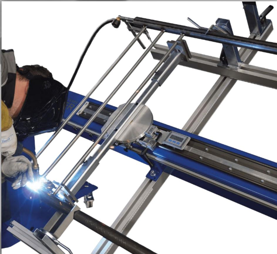
Füllstab oder Stützstab **einlegen - heften - fertig.**
