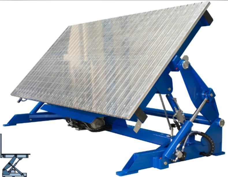
• Punktlasten bis 1,5 t • Flächenlasten bis 2,0 t • Oberflächenebenheit Schiene +/- 0,05 mm • weitere Varianten auf Anfrage
