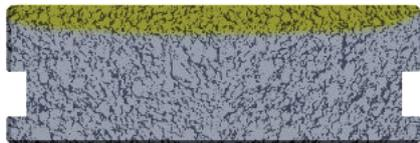
Grauguss altert und mit dieser Alterung diffundieren Graphitanteile an die Oberfläche, was sich in einer zunehmend grauen Färbung ausdrückt und damit einen grundlegenden Schutz vor Schweissritzeranhaftungen bietet.
